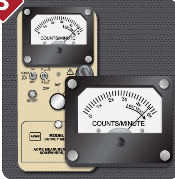
Encienda el instrumento y realice una revisión de la batería. Reemplace si es necesario.
